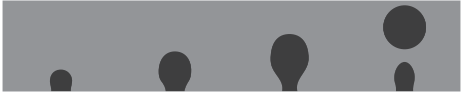
3. ábra. Falról leváló buborék rács-Boltzmann szimulációja.
