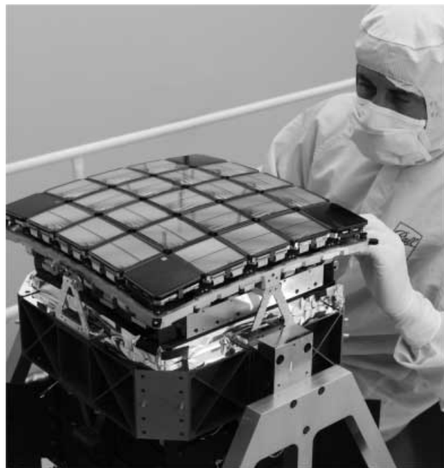
5. ábra. A Kepler-űrtávcső görbült fókuszfelületére illeszkedő detektorrendszer a laboratóriumban
