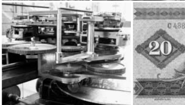
15. ábra. A Pénzjegynyomdában használt biztonsági és díszítő mintázatokat előállító rajzgép és a vele készült pénzjegyek részletei.
