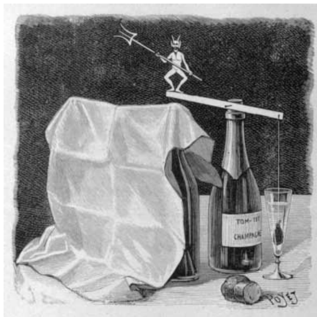
1. ábra. A pezsgőben fel-le mozgó szőlőszem egy léchez köthető, melynek másik végére kis tárgyak helyezhetők.
