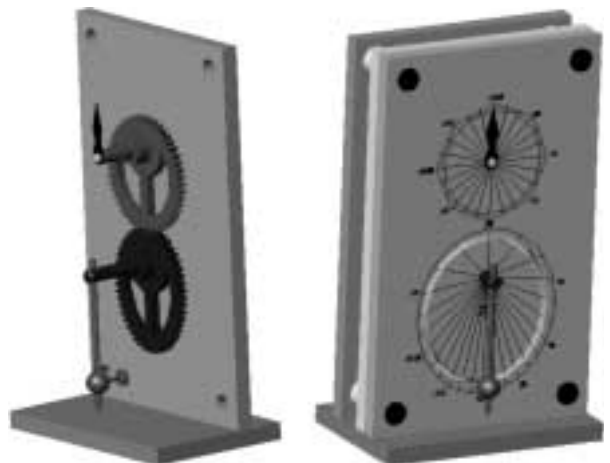
13. ábra. Az elvileg egzakt cometaryum-mechanizmus CAD-modellje
