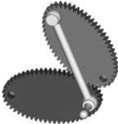
10. ábra. Változó szögsebességű mozgást megvalósító elliptikus fogaskerékpár
