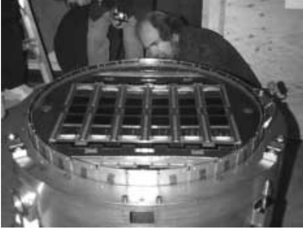
6. ábra. Az SDSS CCD-kamerája, háttérben tervezőjével, Jim Gunnal. A kis négyzetek különálló CCD-chipek, a rájuk szerelt színszűrőkkel. ( http://www.sdss.org )
