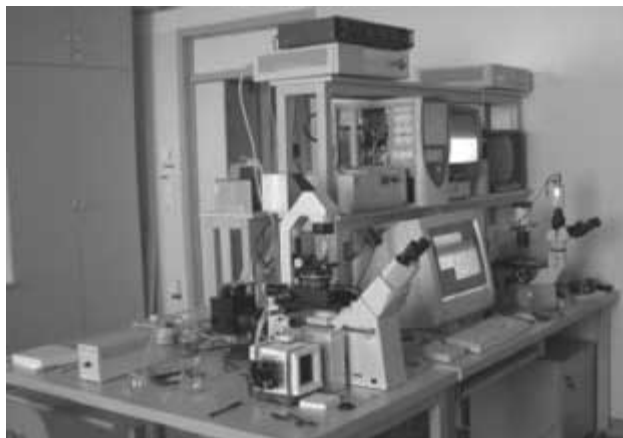
3. ábra. Élő sejtek vizsgálatára alkalmas videomikroszkópiai laboratórium egy automatizált fluoreszcens és egy fáziskontraszt-mikroszkóppal. A Tanszéken fejlesztett szoftver és hardver vezérli a mikroszkópok asztalának nagy pontosságú mozgását, a látómezők élesre állítását, az exponálást és a digitális képek letöltését. Az élő sejteknek megfelelő hőmérsékletet saját fejlesztésű mini inkubátorokban állítjuk elő, melyek a mikroszkópok asztalára illeszthetők.
