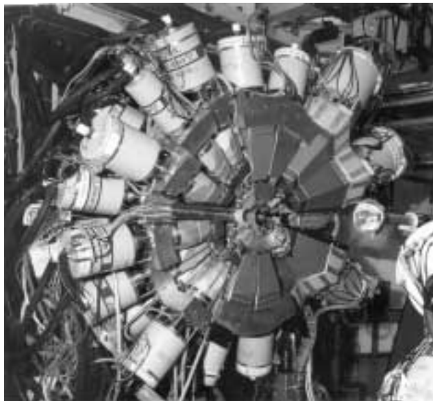
4. ábra. Az EUROBALL \gamma -spektrométer Ge- és BGO-detektorainak fényképe. A céltárgy a kép középpontjában helyezkedik el. A külső részen elhelyezkedő folyékony nitrogént tartalmazó Dewar-edények a detektorok hűtésére szolgálnak. (A spektrométer ára hozzávetőleg 5 milliárd Ft.)
