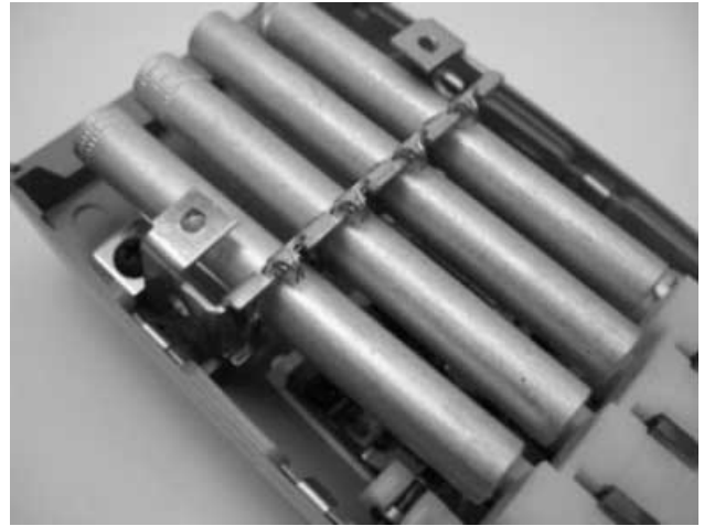
3. ábra. A Robert Adler konstruálta első, ultrahangos TV-távírányító sek zsákmányuk felderítésére 170 000 Hz-ig terjedő ultrahangokat is kibocsátani.
