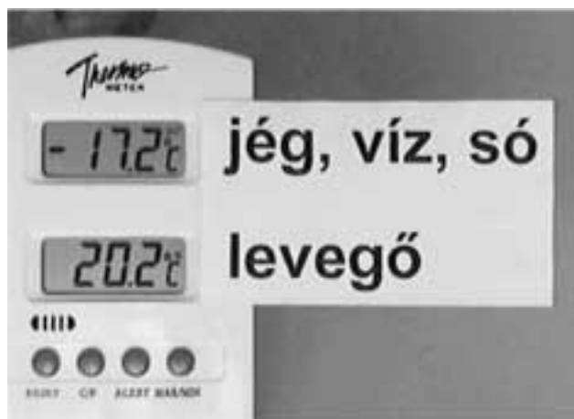
12. ábra. Mérés a digitális hőmérővel
