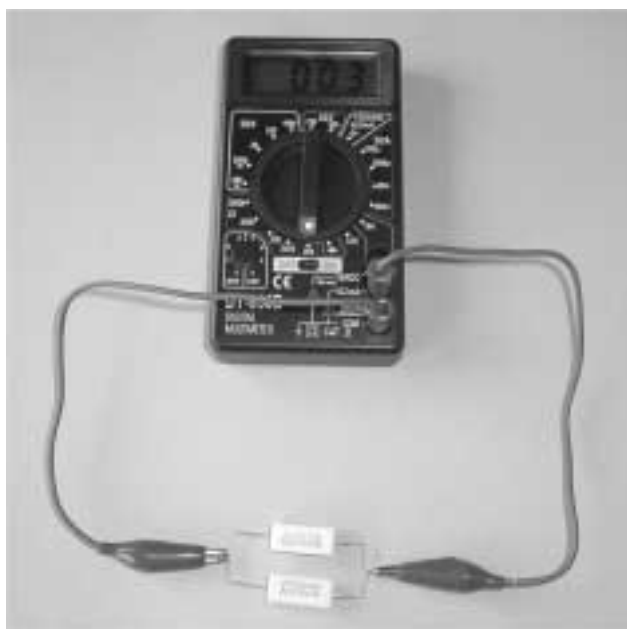
13. ábra. Ellenállásmérés digitális műszerrel
