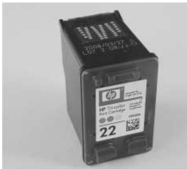
1. ábra. A tintasugaras nyomtató tintapatronja
