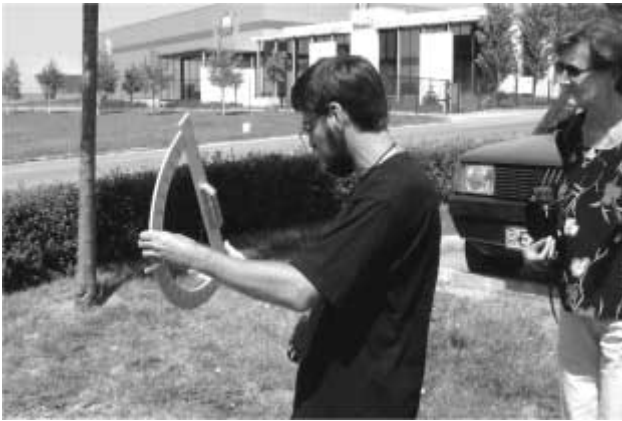
1. ábra. A szélességi kör meghatározása délben, szögmérővel
