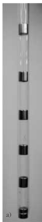
4. ábra. Taszítóerő távolságfüggésének mérése a lebegő mágnesekkel, a taszítandó tömegek változtatásával a), a mérés eredménye b) és a hatványjelleg igazolása c).
