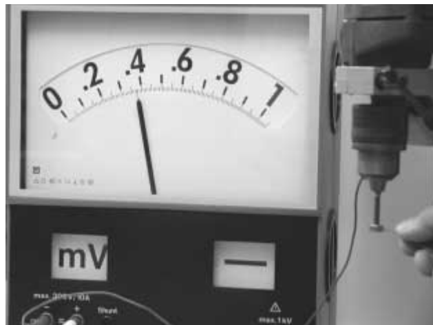
12. ábra. A motor fordítottja, a generátor
