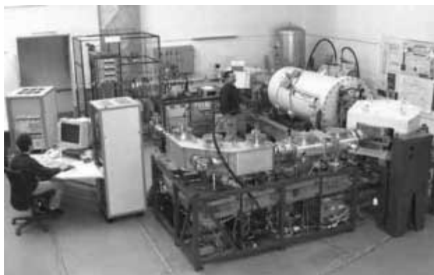
3. ábra. Kompakt AMS-rendszer a svájci PSI Intézetben.
