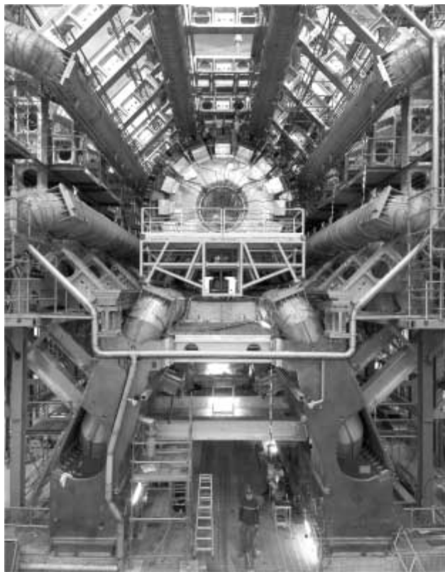
1. ábra. Az ATLAS detektor
