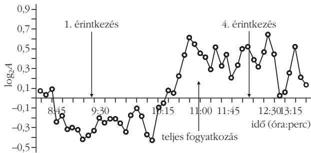
6. ábra. Az FLR-típus helyi periódusánál észlelt pulzációk amplitúdóaránya (Budkov/Nagycekn) a napfogyatkozás időpontja körül. Az időlépték a meghatározás módszere miatt nem egyenletes.
